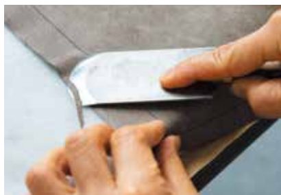
補修革の段差をなくすため革漉き包丁で漉く
