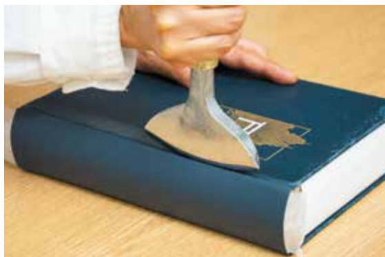
いちょうゴテでの溝付け
